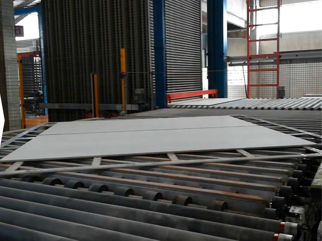
» Tavola rotante 90°/180° in linea 90°/180° rotating table (down the line)
