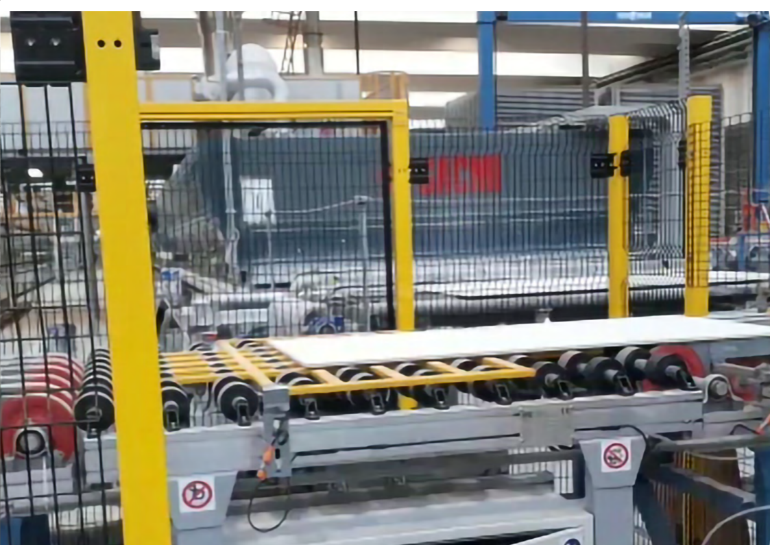
» Tavola rotante 90° in linea 90° rotating table (down the line)
